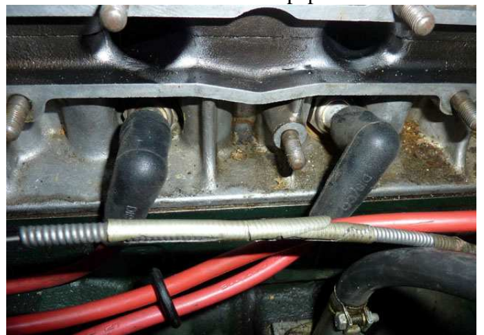
Capuchons de fils soudés pour les 2 bougies centrales
