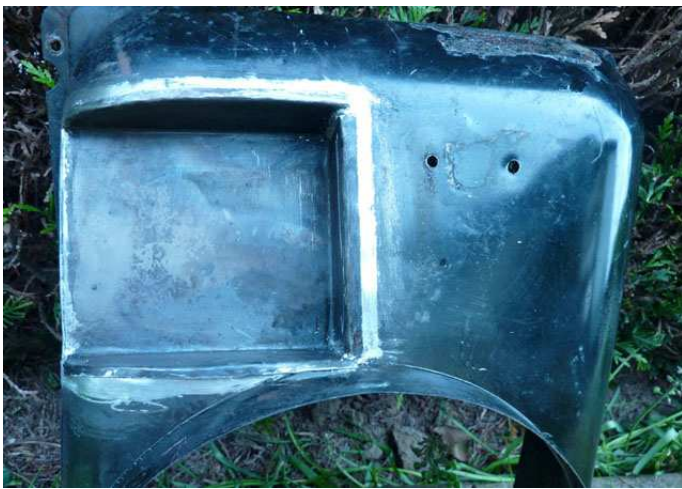
Mise en place et soudage
