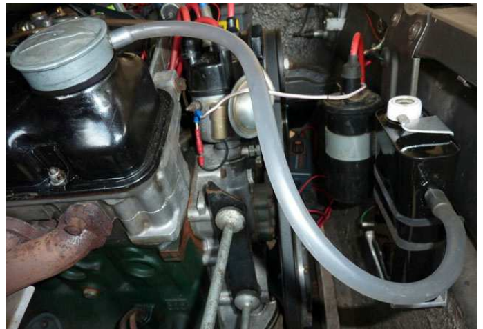
Bâche de récupération des vapeurs d'huile en place
